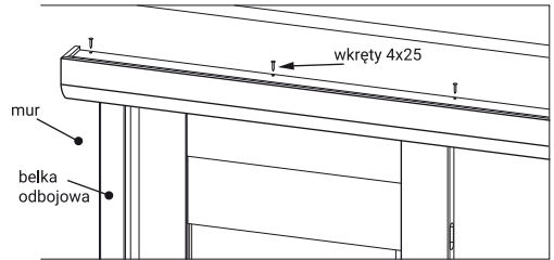
rys. 3 - Zamocowanie maskownicy do systemu przesuwego
